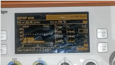
Im BIPAP-Modus führt die Kompression der transparenten Flowmessleitung nach wenigen Atemzügen zur Alarmmeldung „MV hoch“ und der Anzeige eines AMV von 35 l/min.
